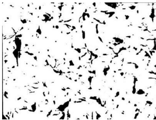
Obr. 2. Výsledky metalografickej skúšky; (a) Veľké grafítové lamely (zväčšenie 100×); (b) Jemnejšie grafítové lamely (zväčšenie 100×). Leptané v 3 % roztoku nitalu.
