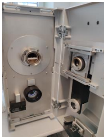
Obr. 1. Analyzátor LECO AF 700 na pozorovanie teploty tavitelnosti popola.
