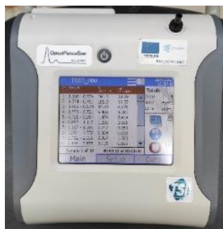
Obr. 1. Zariadenie TSI OPS 3330 na meranie hmotnostnej koncentrácie aerosólov.
